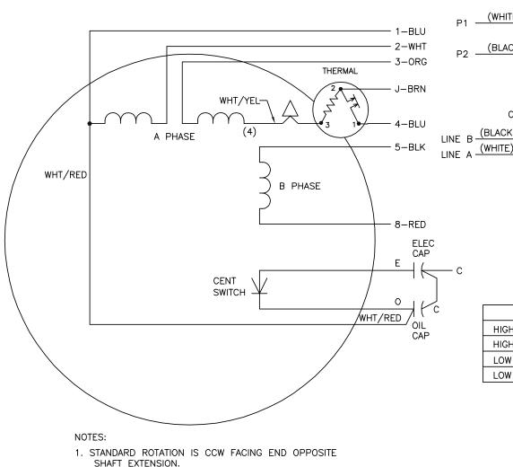
LINE A LINE B JOIN JOIN JOIN HIGH STD 1,P1 2,3,5,P2 C,8 HIGH OPP 4 1,P1 2,3,8,P2 C,5 LOW STD 1,3,P1 4 2,5,J,P2 C,8 LOW OPP 1,3,P1 4 2,8,J,P2 C,5
