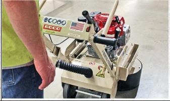
OPERATOR POSITION w/DUAL-DISC GRINDER (FROM HANDLEBARS)
